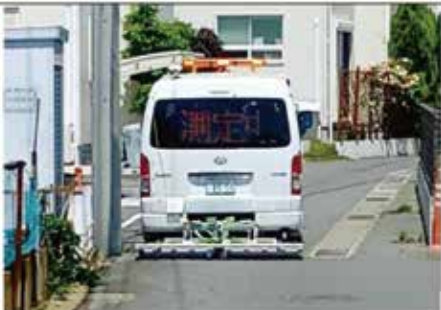
地中レーダーを搭載した探査車による調査
